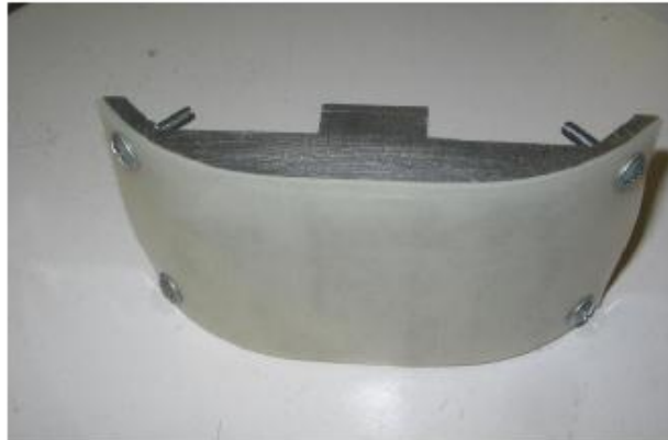
شکل ۱۰- تصویری از پای آزمون به همراه پوست سیلیکونی متصل به آن
