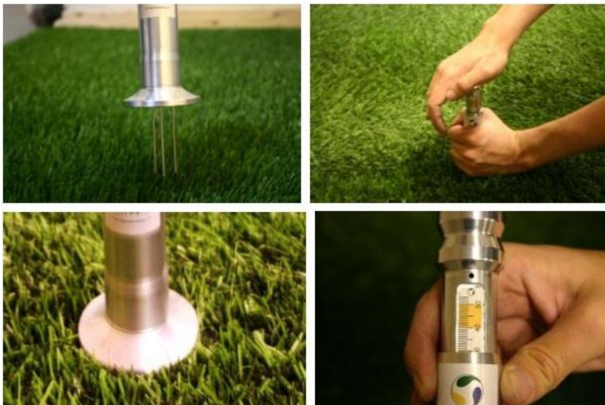
شکل ۲۷- دستگاه عمق سنج برای اندازه‌گیری ضخامت پرکننده
